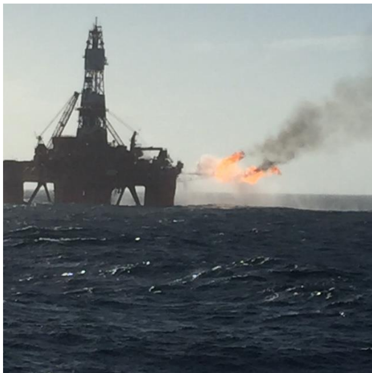
Figur 7.1: Dannelse av sot ved oppstart brenning av olje
