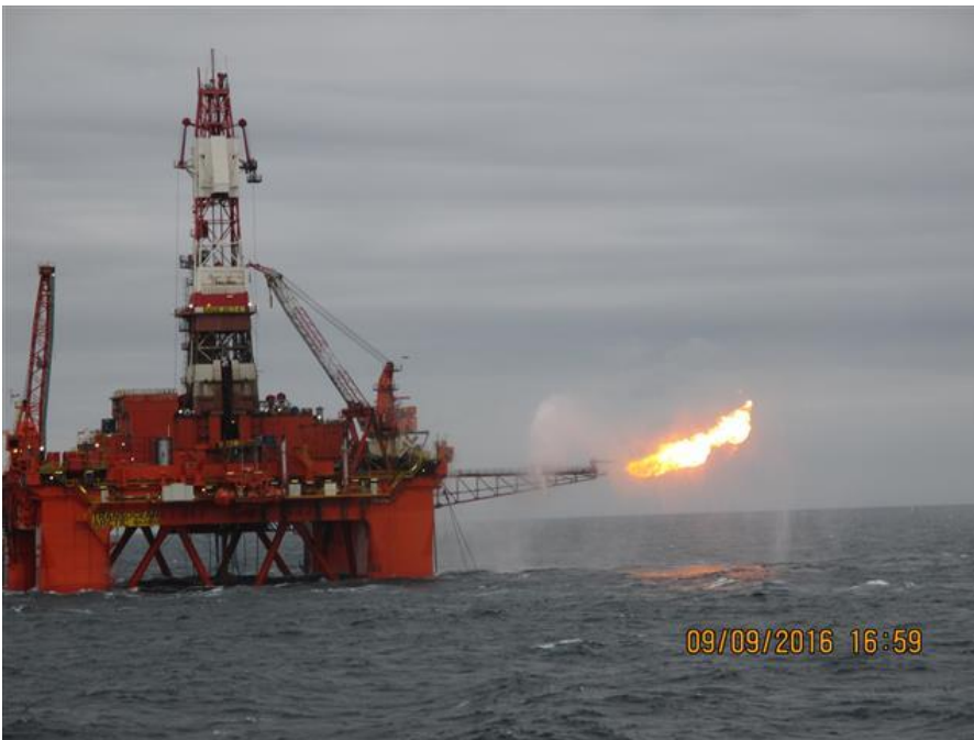
Figur 7.2 Brenning av gass under brønntest
