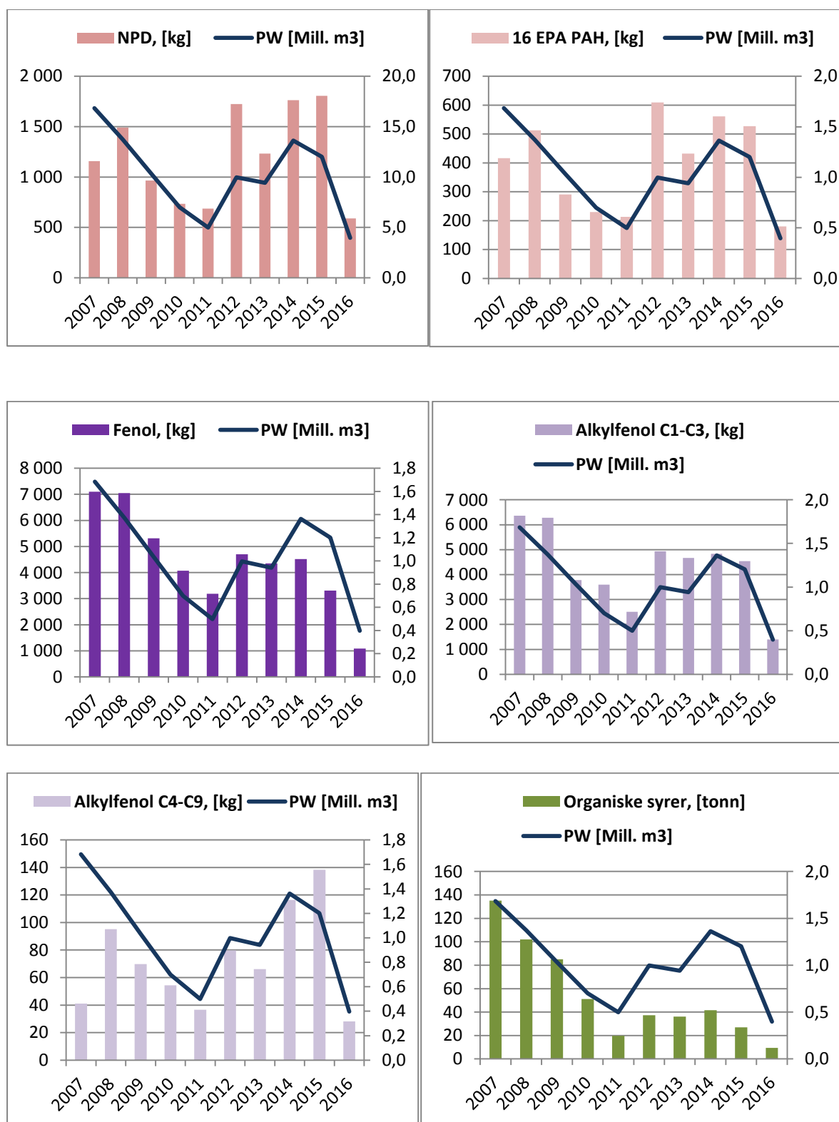
Figur 3.4 Historisk oversikt for utslipp av løste forbindelser i produsert vann på Varg
